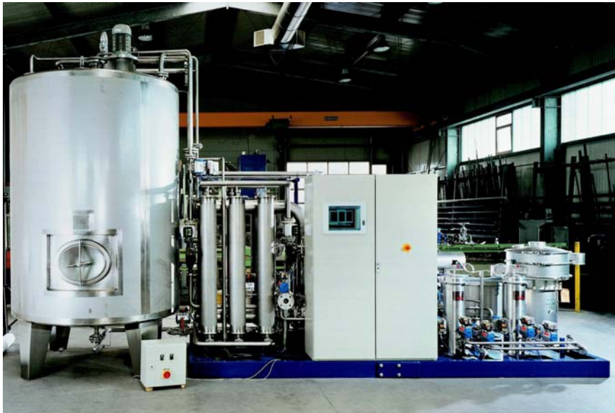
Anlage zur Aufbereitung der Textilschichten (mit freundlicher Genehmigung der RESCOM ENGINEERING GmbH)
